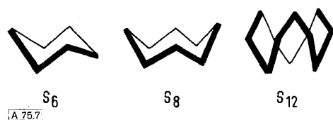
Abb. 7. Strukturen von S_6 , S_8 und S_{12} . Die Atome liegen abwechselnd in zwei bzw. drei zueinander parallelen Ebenen.
